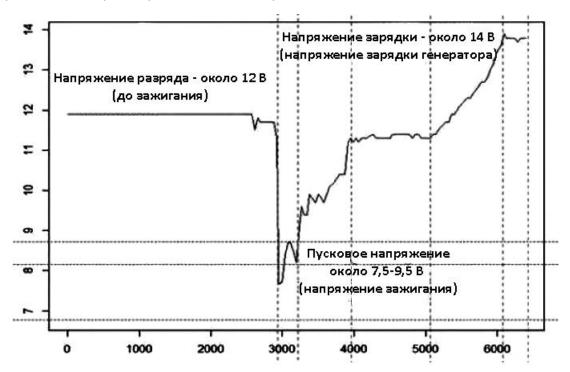
• Напряжение разрядки: при выключенном зажигании и выключенном двигателе (более 20 минут) напряжение разрядки должно быть около 12 В. Если напряжение разряда ниже 11 В, будет трудно
