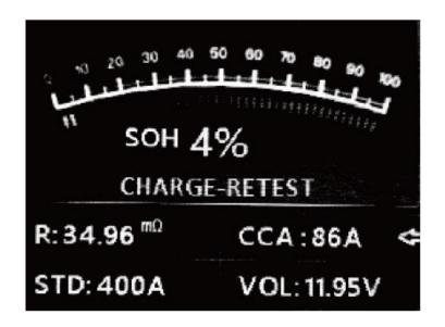
Нестабильная батарея должна быть перезаряжена и протестирована повторно перед использованием. Если после зарядки и повторной проверки появляется тот же результат, батарея считается поврежденной, замените ее и не используйте.
