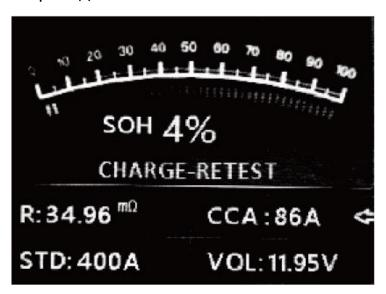
Нестабильная батарея должна быть перезаряжена и протестирована повторно перед использованием. Если после зарядки и повторной проверки появляется тот же результат, батарея считается поврежденной, замените ее и не используйте.
