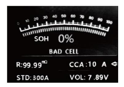
Внутренняя часть батареи повреждена, поврежден элемент или короткое замыкание, замените батарею.
