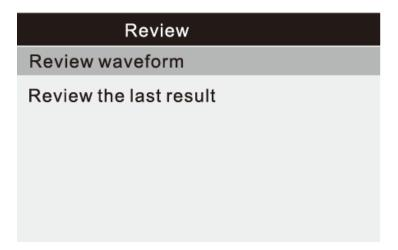
1. С помощью кнопок BBEPX/BHИ3 выберите Review the last result (Просмотр последнего результата) и нажмите Enter для подтверждения выбора. На экране отобразится следующее:
