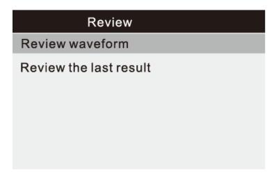
1. С помощью кнопок ВВЕРХ/ВНИЗ выберите Review waveform (Просмотр осциллограммы) и нажмите Enter для подтверждения выбора. На экране отобразится следующее:
